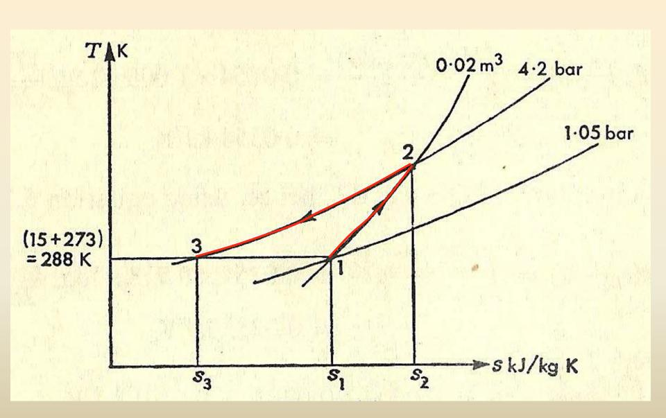
من علاقة القانون العام كتلة الهواء  $m=(P.V)/(R.T)=(1.05^*10^5*0.02)/(0.287^*10^3*288)$  m=0.0254 kg  $V_1=V_2,\,P_1V_1=mRT_1 \Rightarrow V_1=\frac{mRT_1}{P_1}$  للغاز المثالي في إجراء بثبات الحجم للخار المثالي في إجراء بثبات الحجم
